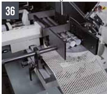
Dispositivo para cortes em feixes e guia regulável para a descarga das peças (máx. 240x90)
