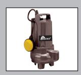
CR-1035 VXC MN Sólidos: máx. 35 Ø mm. Profundidad máx.:9 m. Rodete y eje motor AISI 304 Diámetro expulsión: 1,5' Tensión: 230 V./ 50 Hz. Peso: 18,7 kg. REF.85860000
