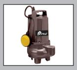
CR- 2050 VXC MN Sólidos: máx. 50 Ø mm. Profundidad máx.:9 m. Rodete y eje motor AISI 304 Diámetro expulsión: 2,5" Tensión: 230 V./ 50 Hz. Peso: 34,8 kg. REF.85860020
