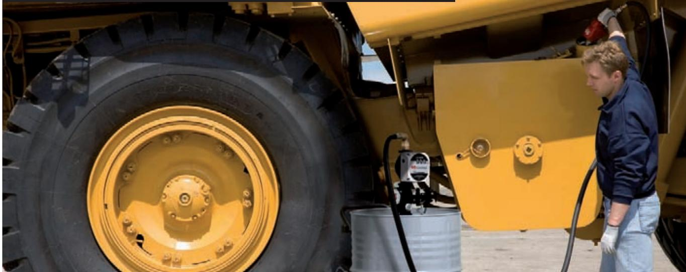
Electrobombas portátiles para el suministro de gasóleo a pie de maquina. Pueden ser acopladas a depósitos transportables ADR para combustibles.
