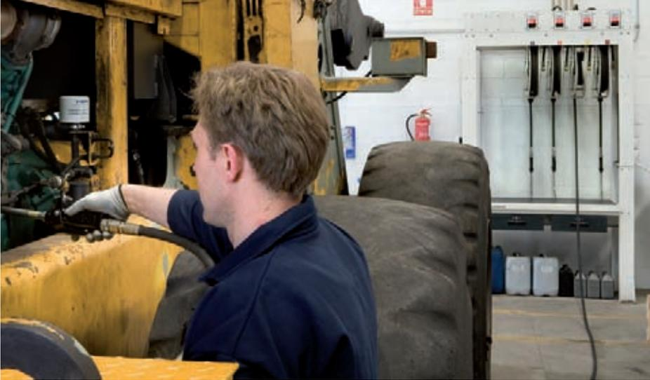
El uso de enrolladores de manguera permite disponer de un amplio radio de flexibilidad para acceder al vehículo en servicio, utilizando únicamente la longitud de manguera necesaria.
