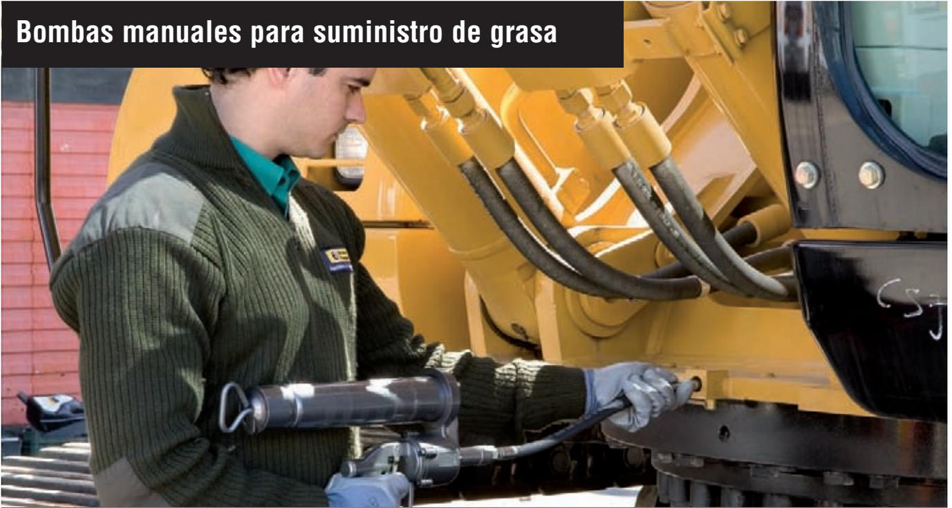
Pistolas neumáticas y bombas para engrase manual, para utilización con grasas consistentes en cartucho o a granel. Indicadas como dotación básica para el mantenimiento a realizar por el operador de máquina.
