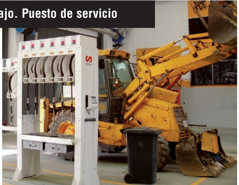
Para una productividad eficaz del centro de mantenimiento, los puestos de servicio deberán situarse próximos a las áreas de trabajo, evitando el desplazamiento de los operarios.
