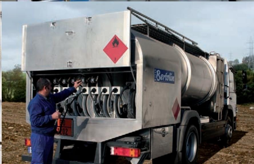
Para el mantenimiento de grandes flotas o el suministro de combustible a maquinaria pesada a pie de obra, los vehículos de servicio carrozados para este uso, son la solución más adecuada.
