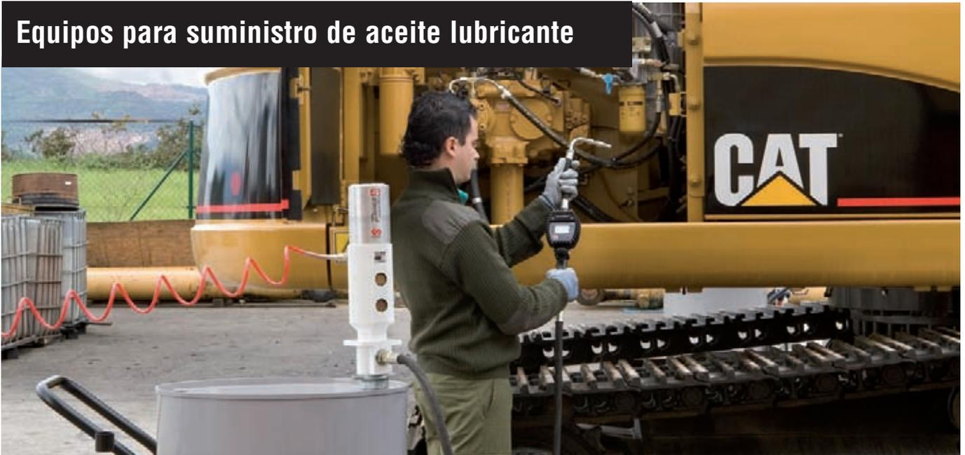
Equipos móviles y soluciones auto instalables para suministro de aceite en talleres y centros profesionales de mantenimiento de maquinaria de movimiento de tierra, construcción o minería.
