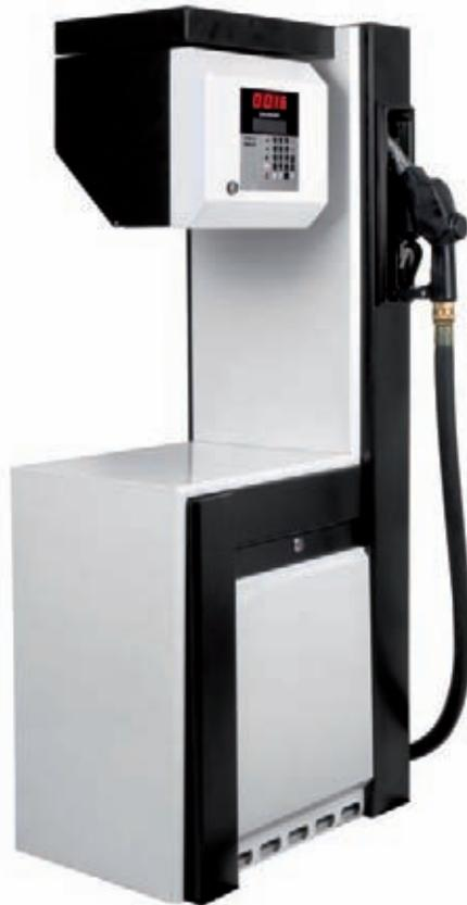
Surtidor para suministro de Gasóleo de abastecimiento privado, con sistema electrónico de control y gestión integrado. Carrocería realizada en acero, con acabado en pintura epoxi de alta resistencia. Suministrado con manguera de servicio (4 m) y boquerel automático. Indicado para instalaciones con depósitos de almacenamiento aéreo o soterrado.
