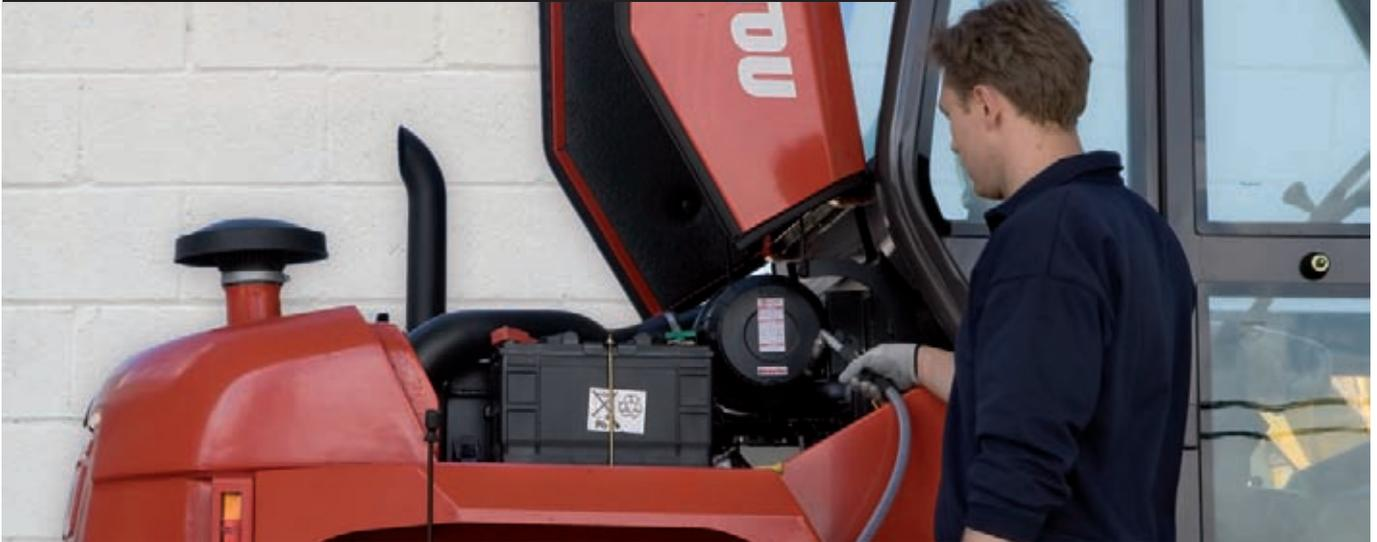
Aceites y refrigerantes usados son residuos nocivos para el medio ambiente que exigen de una correcta manipulación. La utilización del equipamiento adecuado evitara las derramas incontroladas y el contacto con la piel.
