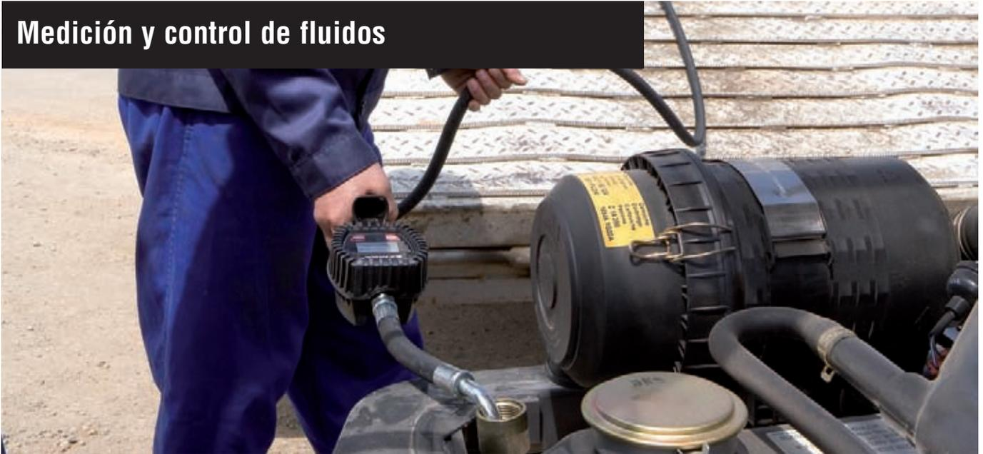
Para una medición precisa, los contadores volumétricos deberán ser calibrados en el campo de aplicación, instalados en la línea y con el fluido a utilizar.
