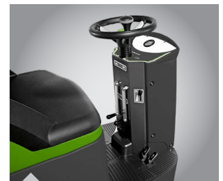
Operação mecânica por alavancas da escova e barra de aspiração
