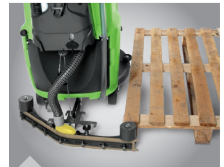
Desengate automático de segurança da barra de aspiração em caso de embate, evita danos no equipamento
