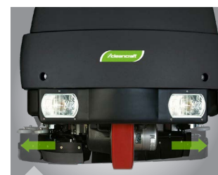
Escovas de limpeza com retracção automática em caso de impacto
