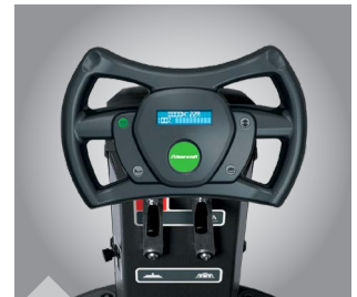
Volante ergonómico com comandos e display digital
