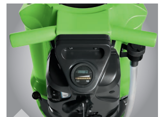
Operação mecânica da escova e barra por alavancas no comando
