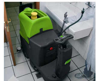
Depósito água limpa com mangueira para facilitar o enchimento do depósito
