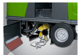
Escovas substituíveis sem necessidade de ferramentas
