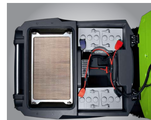
Duas baterias de 12V para até 4h de operação sem interrupções nem emissões
