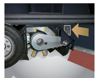
Escovas substituíveis sem necessidade de ferramentas. Pressão e ajuste de altura do rolo principal são ajustáveis separadamente
